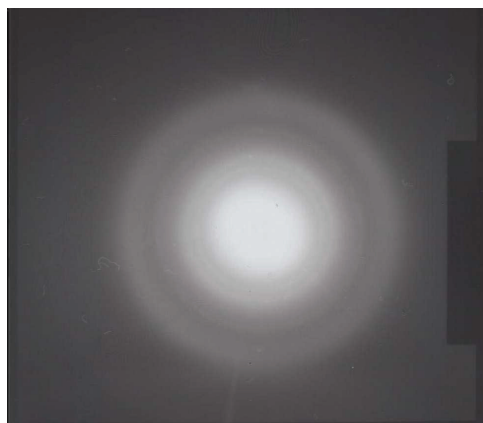
図 2-15 焼成後のチタニアナノ粒子の電子線回折
