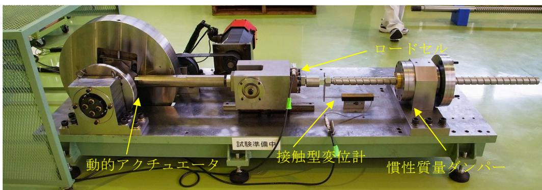
図 3.7 加力実験設置状況
