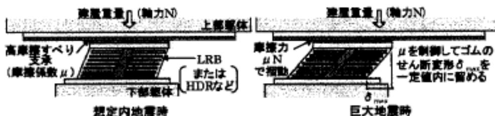
図 1.9 滑り機構付き積層ゴムの概要
