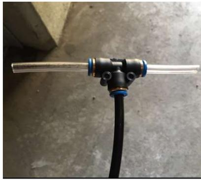
図 2-2-4 静圧測定装置 [単位 : mm]
