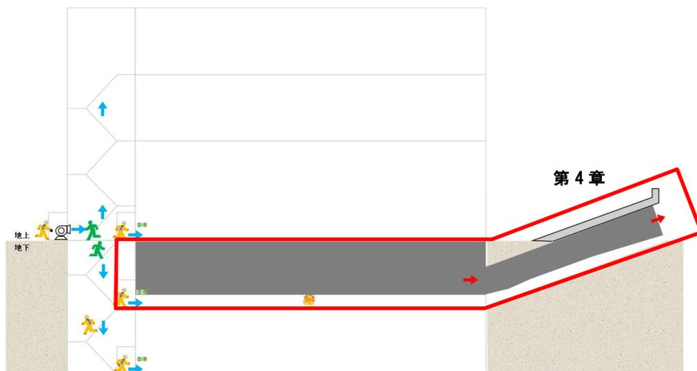
(c) 加圧給気による地下空間における熱気流性状
