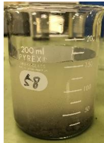
図 3.1-11 ヘキサメタリン酸ナトリウム溶液にエージング処理ありの製鋼スラグを投入してから5時間後の様子
