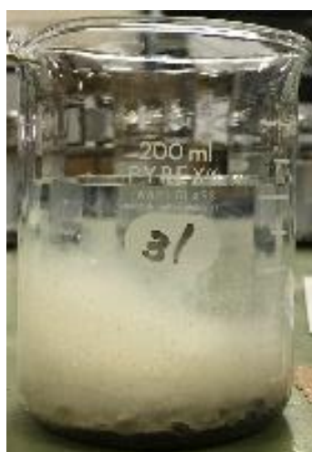
図 3.1-13 ピロリン酸ナトリウム溶液にエージング処理ありの製鋼スラグを投入してから5時間後の様子
