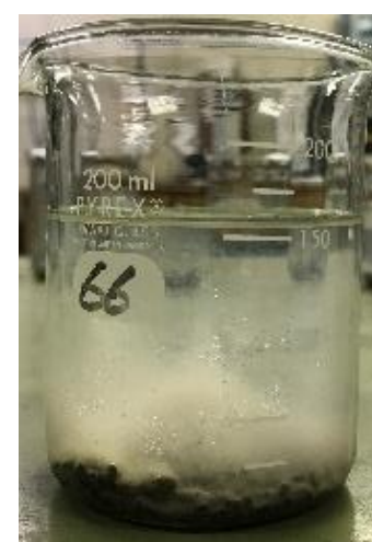
図 3.1-13 ピロリン酸ナトリウム溶液にエージング処理ありの製鋼スラグを投入してから5時間後の様子
