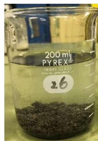
図 3.1-14 ピロリン酸ナトリウム溶液にエージング処理なしの製鋼スラグを投入してから5時間後の様子
