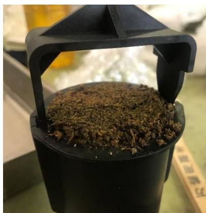
図 3.4-2 動的な取り出しによる端面の欠損
