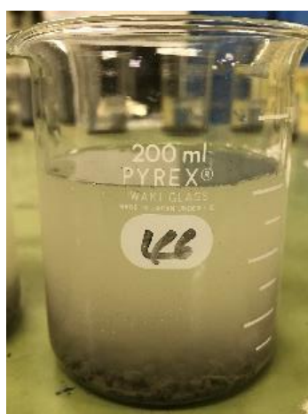
図 3.1-11 ヘキサメタリン酸ナトリウム溶液にエージング処理ありの製鋼スラグを投入してから5時間後の様子
