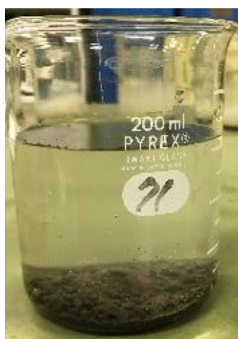
図 3.1-14 ピロリン酸ナトリウム溶液にエージング処理なしの製鋼スラグを投入してから5時間後の様子
