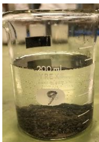
図 3.1-12 ヘキサメタリン酸ナトリウム溶液にエージング処理なしの製鋼スラグを投入してから5時間後の様子
