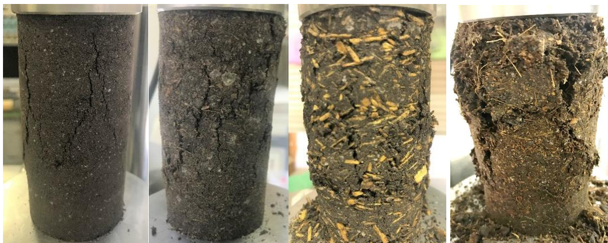
(a)スラグ 4(2018)のみ (b)ヒノキ 33vol.% (c) カラマツ 33vol.% (d)ココヤシ繊維 33vol.% ( \varepsilon_a = 1.2\% ) ( \varepsilon_a = 3.7\% ) ( \varepsilon_a = 5.4\% ) ( \varepsilon_a = 15.6\% )
