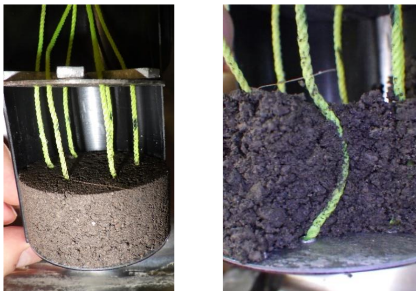
図 5.1-1 締めによる供試体中の化学繊維のたわみ
