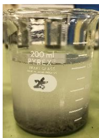
図 3.1-11 ヘキサメタリン酸ナトリウム溶液にエージング処理ありの製鋼スラグを投入してから5時間後の様子
