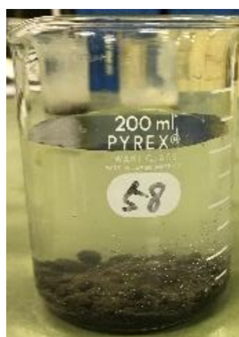
図 3.1-14 ピロリン酸ナトリウム溶液にエージング処理なしの製鋼スラグを投入してから5時間後の様子
