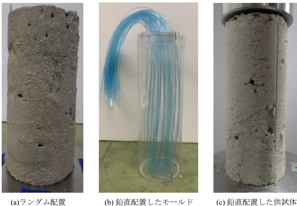
図 5.1-10 ナイロン繊維を配置した石膏複合固化材供試体とプラスチックモールド
