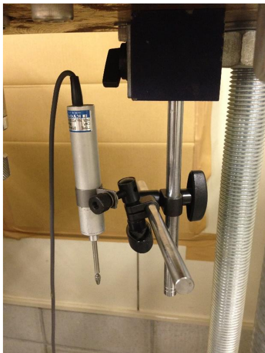
図 3.5-3 外部変位計 LVDT
