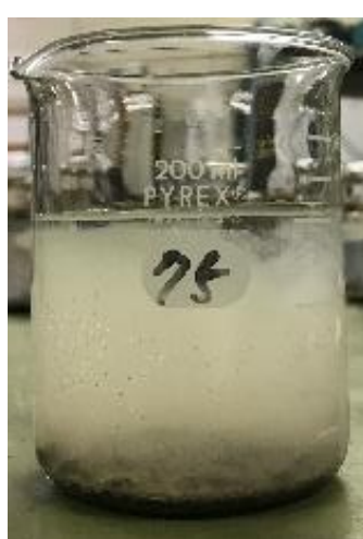
図 3.1-13 ピロリン酸ナトリウム溶液にエージング処理ありの製鋼スラグを投入してから5時間後の様子
