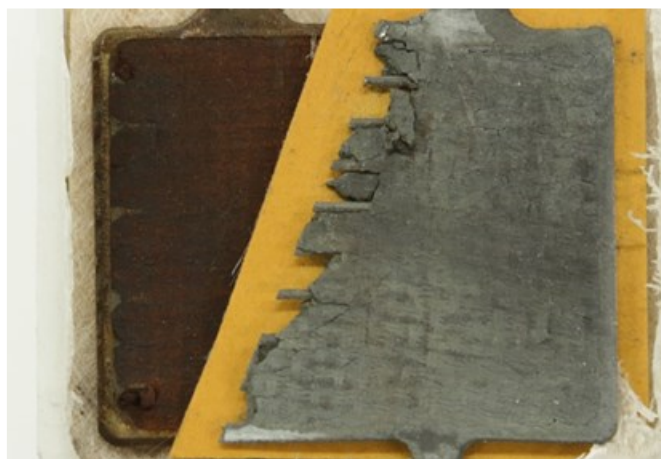
図 2.4.1 市販の二輪自動車用鉛蓄電池 6N4-2A-4（GS YUASA 製）の電極
