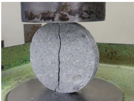
写真 3.10 スライス引張試験状況
