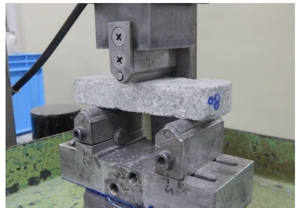
写真 3.9 スライス曲げ試験状況
