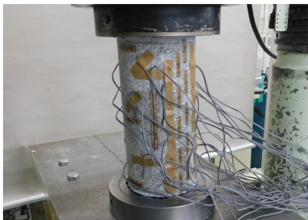
写真 4.4 ひずみゲージ貼付位置と圧縮強度試験
