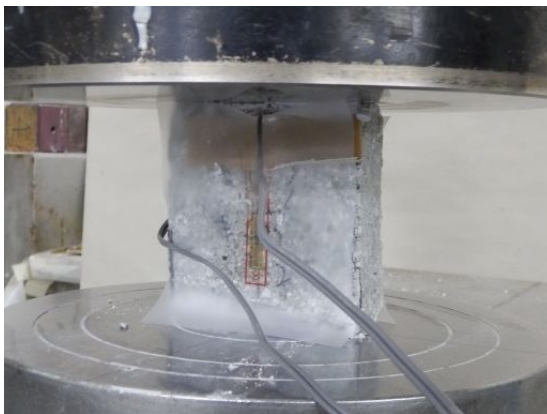
写真 3.8 スライス圧縮試験状況
