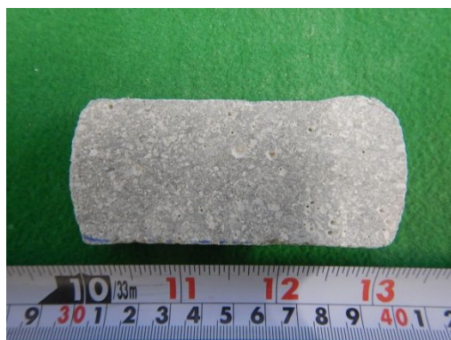
写真 3.6 スライス曲げ試験片の状況
