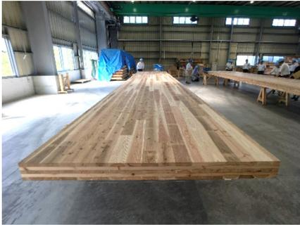
Photo 2-1 Cross-Laminated Timber (CLT) 長さ 12.0m の大型木質パネル
