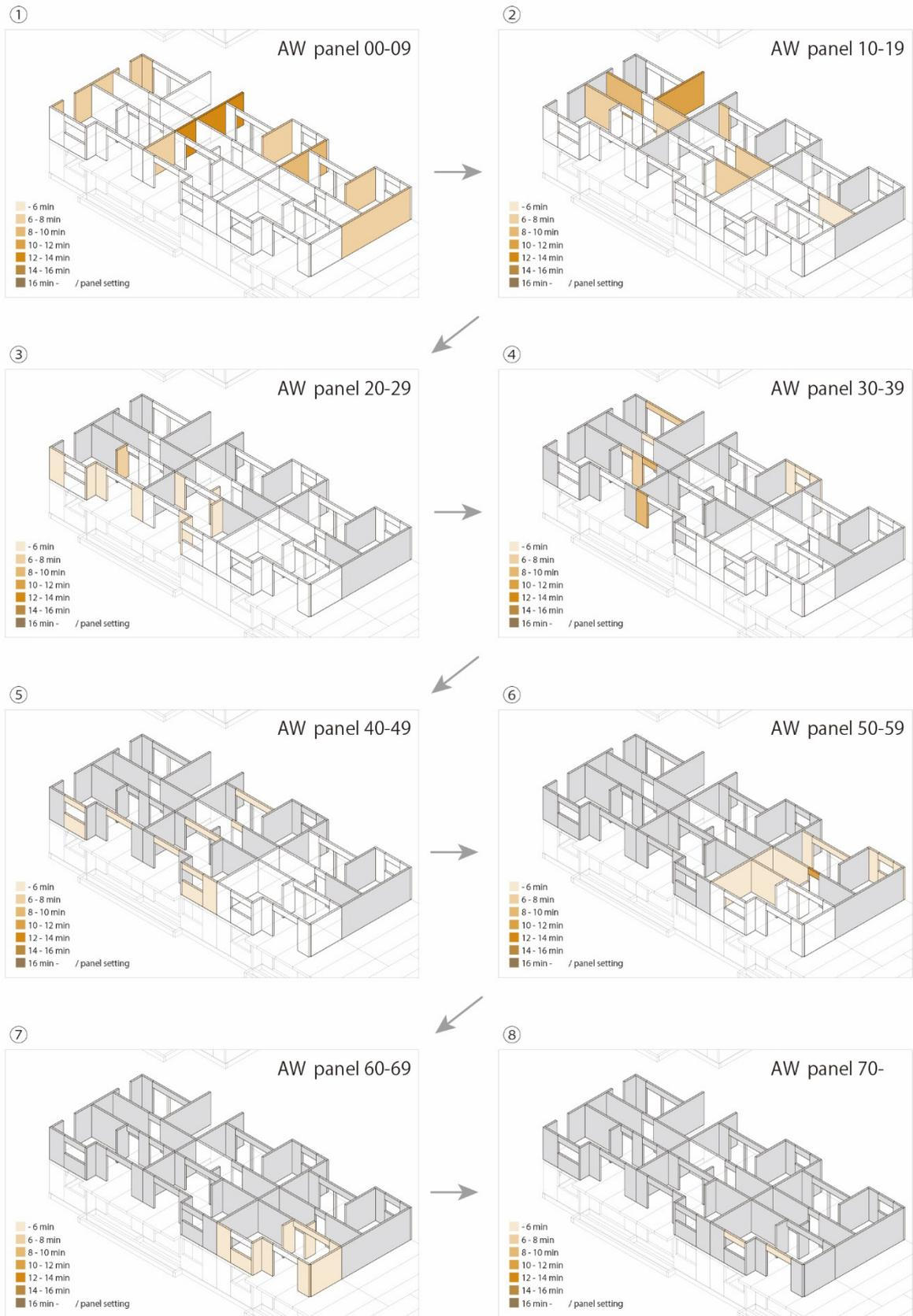
Fig. 4-18 AW 棟 2 階部分の壁パネルセット作業順序と作業時間の関係
