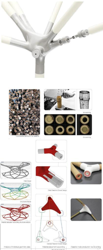
Fig.2-13 シンガポール工科大学による、3D スキャン・3D プリンターを用いた竹建築に関する研究、SUTD Bamboo Research combines 3D scanning, optimization and 3D Printing (展覧会カタログより引用)
