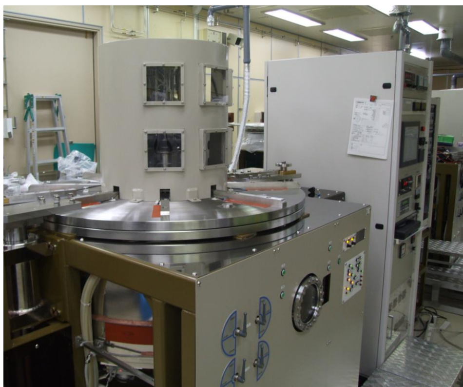
図 2.19 本研究で用いたマグネトロンスパッタリング成膜装置の外観
