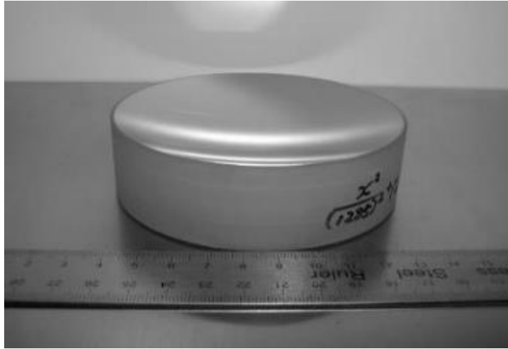
図 2.23 作製した広帯域・高 NA Mo/Si 多層膜反射鏡の外観。基板の直径は 100 mm、基板淵厚は 30 mm で、基板材料は Zerodur™ [41]（低熱膨張ガラス材料）、表面粗さは 0.45 nm (RMS) である。
