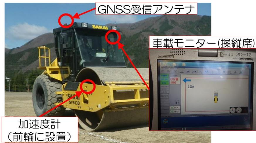
図 2-13 CCV システムの概要
