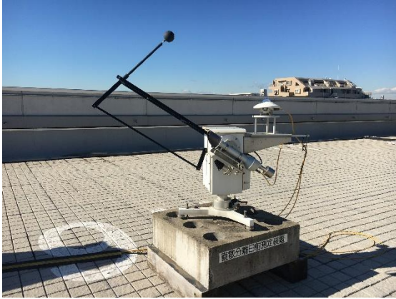
プリード社 直達日射計 CHP1 自動追尾装置 ASTX-2 太陽光遮蔽装置 PO-155-1/OM
