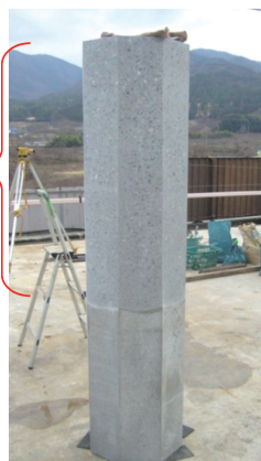
写真4 PC工場での試作品（高3m）
