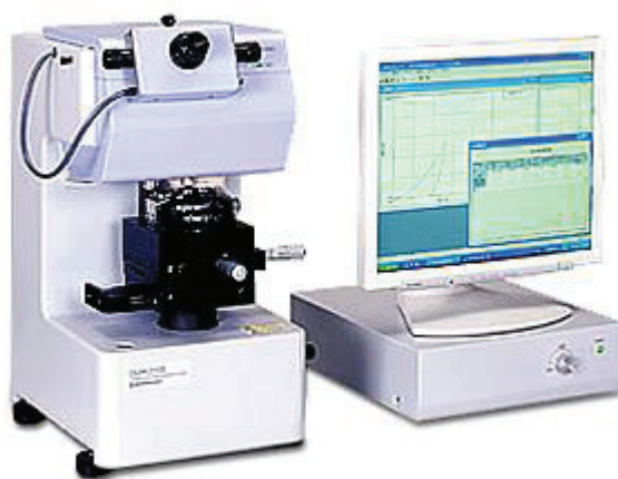
図 30 : 島津製作所製、ダイナミック超微小硬度計 DUH-211
