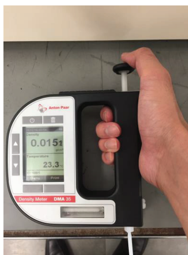
Fig. A-7 DMA 35 ® portable density meter
