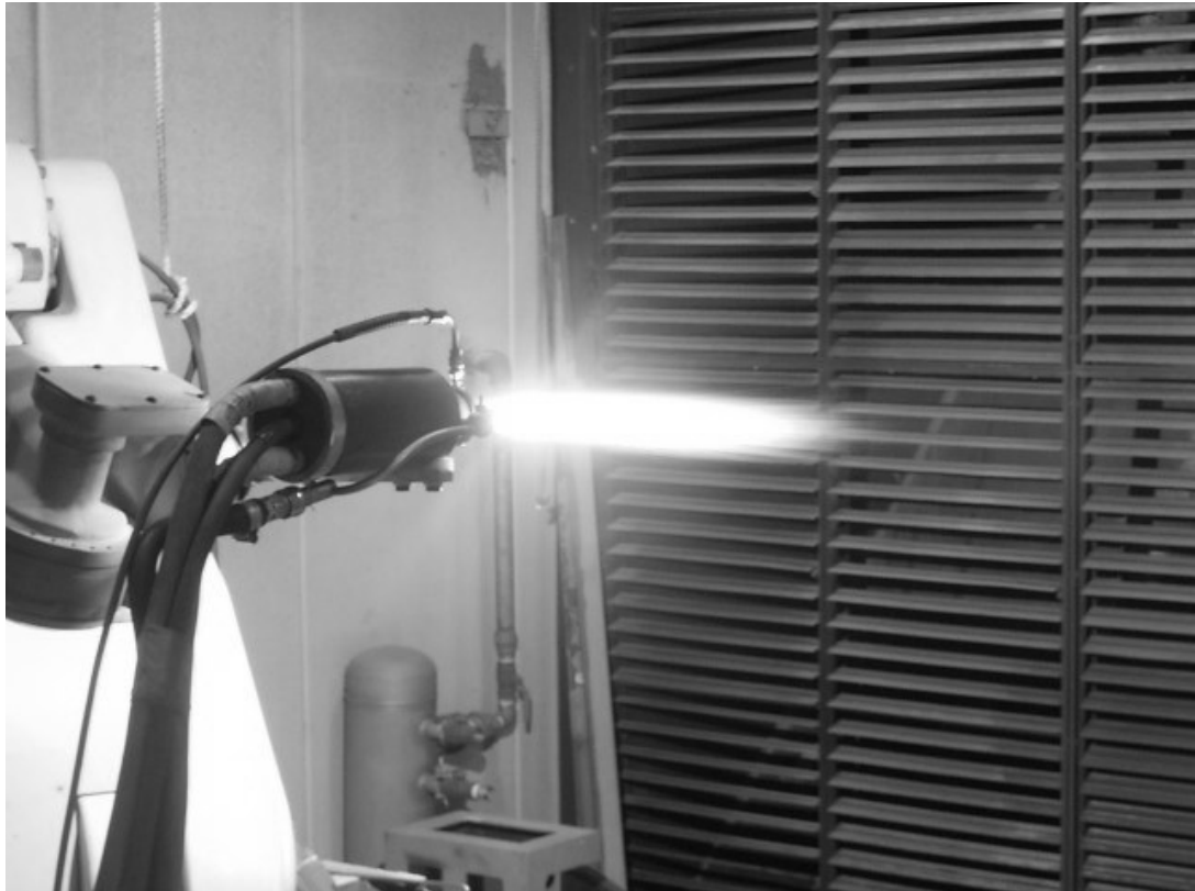
図 1-3 APS 溶射ガンの外観写真 Fig.1-3 Photograph of a APS gun.
