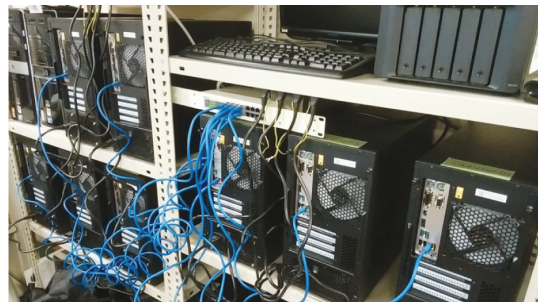
写真2 8台のノードを接続したクラスタ
