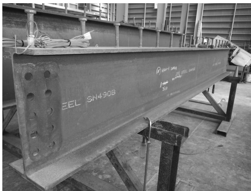
図 2.28 スタッドひずみゲージ設置状況（写真）
