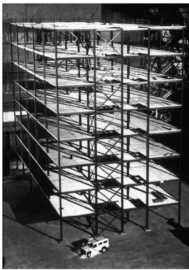
図 1.9 Cardington Fire Tests 実大鋼構造骨組（写真）
