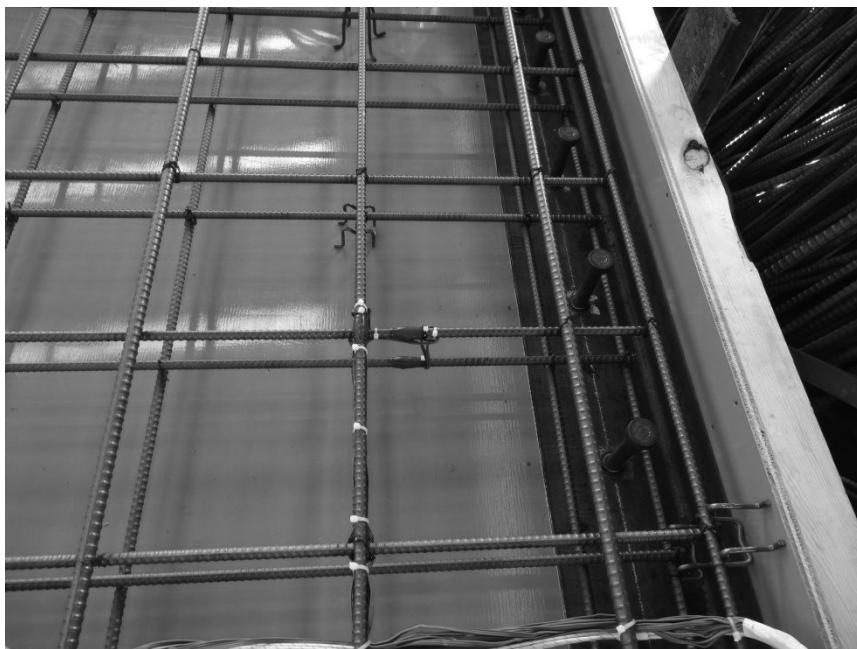
図 2.26 RC スラブ鉄筋ひずみゲージ設置状況（写真）
