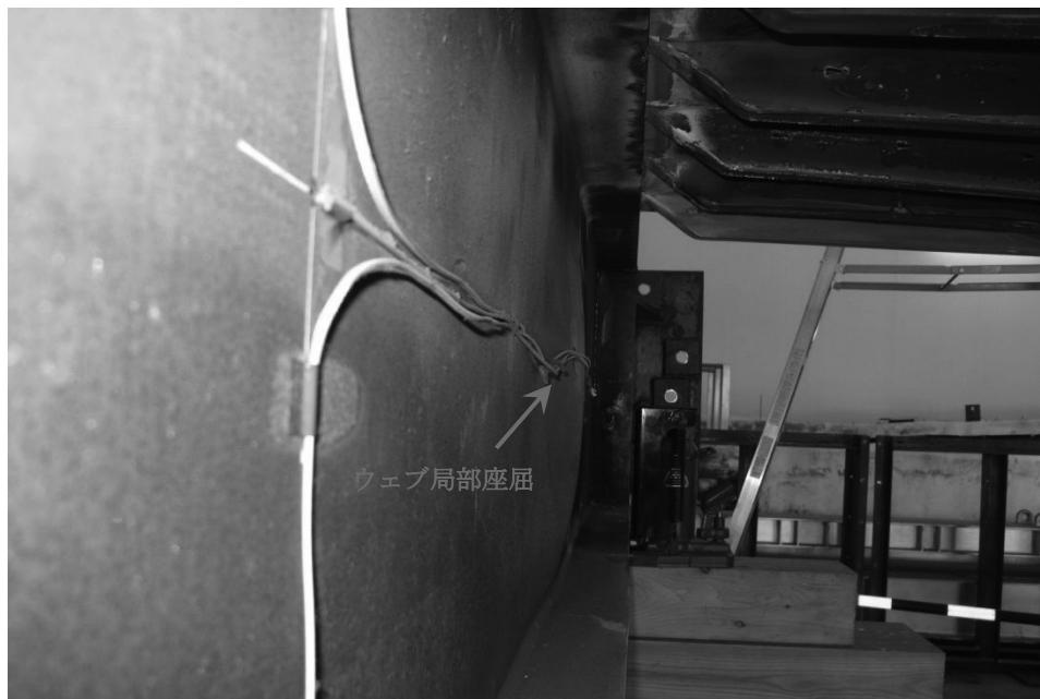
図 4.10 実大部分架構試験体での加熱梁ウェブの局部座屈（写真）
