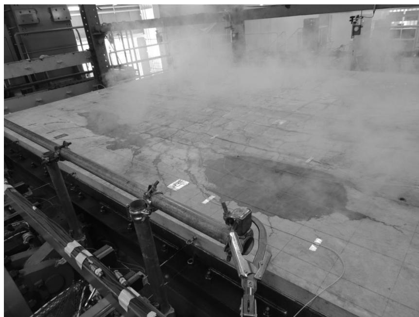
図 2.60 H600-1\_固定端側 RC スラブひび割れ発生状況（写真）
