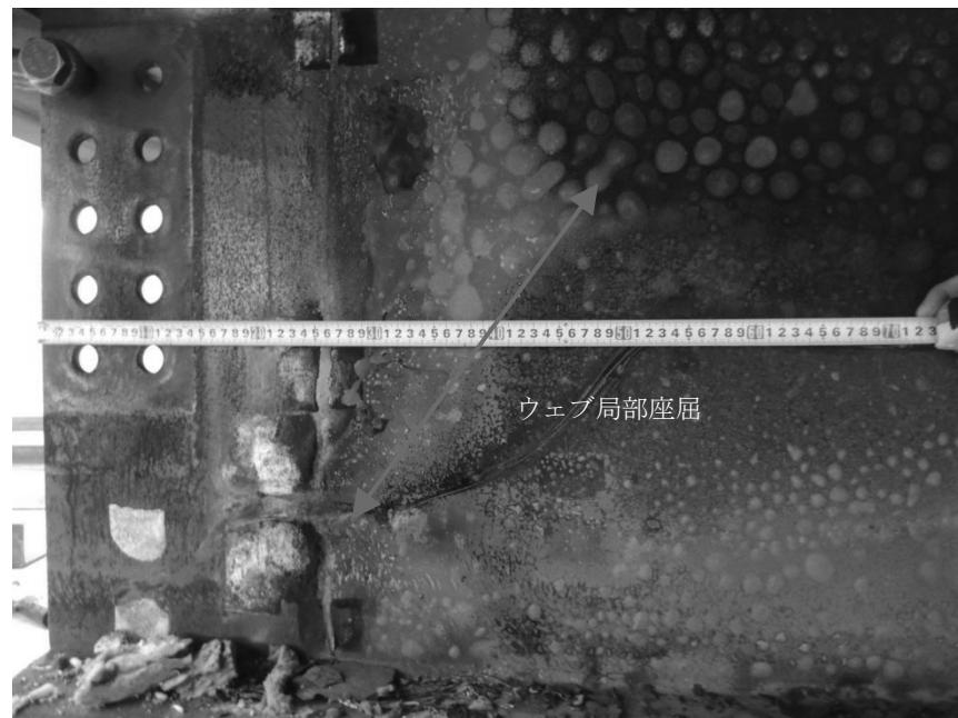
図 3.19 H600-1 加熱梁固定端側のウェブ局部座屈（写真）
