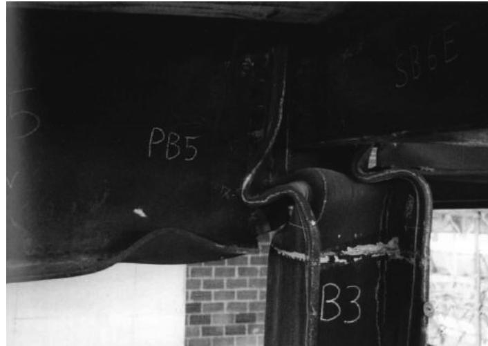
図 1.12 Cardington Fire Tests 鋼梁および鋼柱の局部座屈 (写真)
