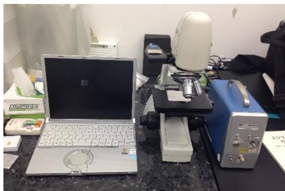
Fig. 2-2-2b 可搬型ラマン分光分析装置 Mini Ram
