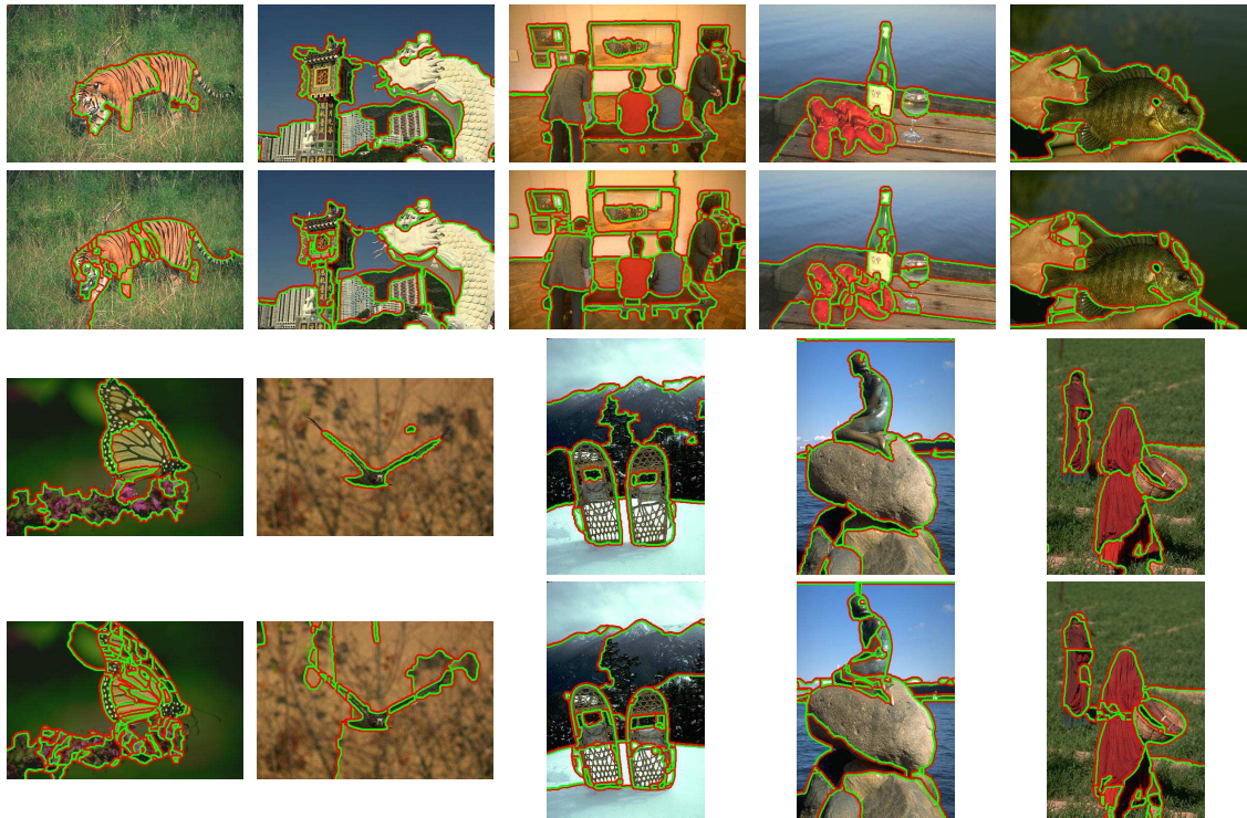
図 4.4 遮蔽境界検出と遮蔽関係推定結果の比較. 奇数行に提案手法による結果, 偶数行に Maire [2] による結果を示す. 赤線が奥側, 緑線が手前側として遮蔽関係を表現している.
