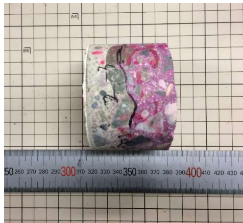
図 3.2-8 中性化深さ測定例（フェノールフタレイン溶液噴射後）
