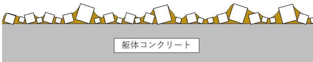
図 5.4-1 薄付け仕上塗材の断面イメージ
