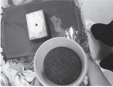
図 13 手摺りに使う研磨（研削）板と研磨粉（左）および研磨中の 治具の様子（右）
