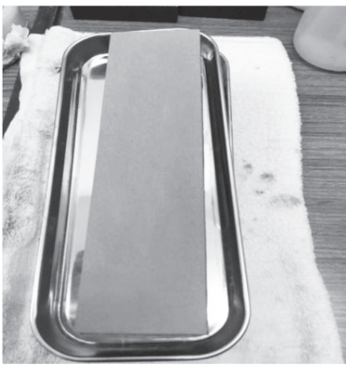
図 15 人造砥石による岩石の研削の様子
