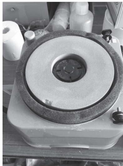
図12 電動研磨機による岩石の研削の様子
