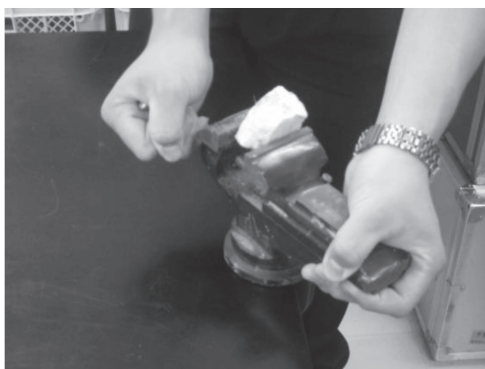
図4 万力を用いた岩石の挟割
