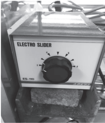
図9 電動工具の回転数調整に便利な変圧器、左が大容量（10A）右が小容量（5 A）
