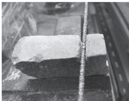
図10 金鋸の歯を岩石用に交換した岩石鋸と切断の様子
