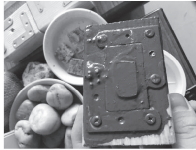
図 13 手摺りに使う研磨（研削）板と研磨粉（左）および研磨中の 治具の様子（右）
