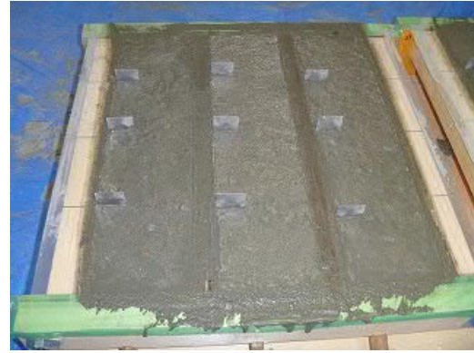
(模擬ひび割れ導入：含水率・中性化測定) (模擬ひび割れ導入：鉄筋腐食測定)
