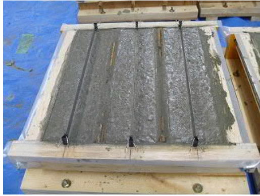
(模擬ひび割れ導入：含水率・中性化測定) (模擬ひび割れ導入：鉄筋腐食測定)
