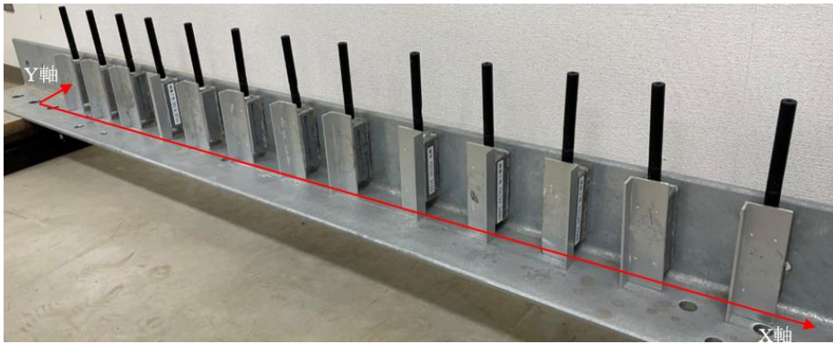
(a) 傾斜センサ設置状況
