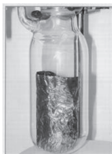
図 4-2 銀色の金属光沢を有するポリアセチレンフィルム
