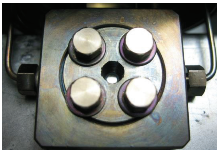
図 2-7 高温高圧液体光学セル
