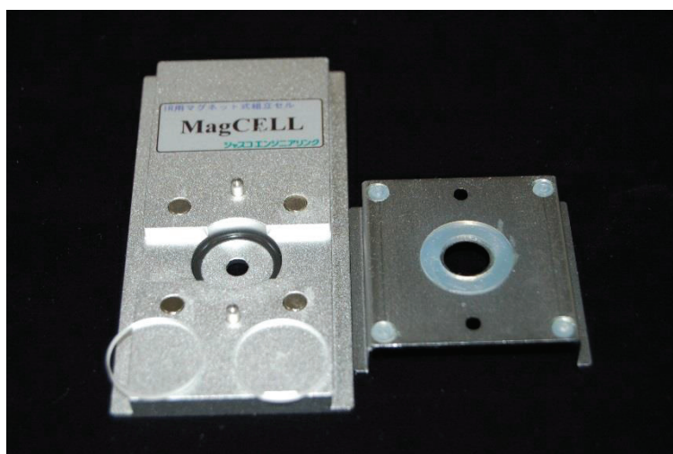
図 2-6 一般的な組み立て式液体セル
