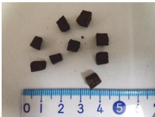
図 3.3.1. 酸化マンガ(IV)を固定したブロック
