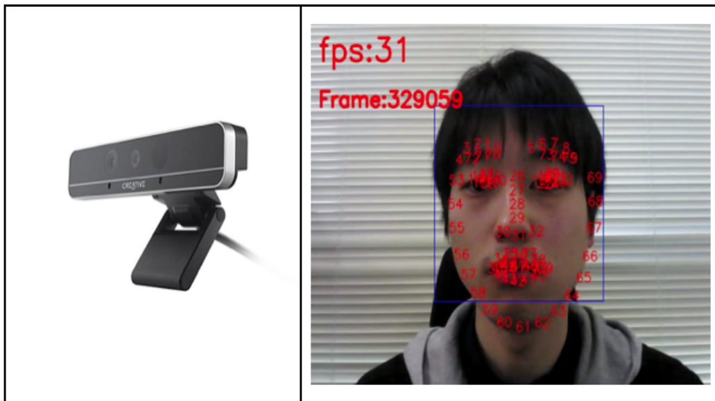
図 4.4: RealSense デバイス (左) と RealSense SDK による顔のランドマーク情報の例
