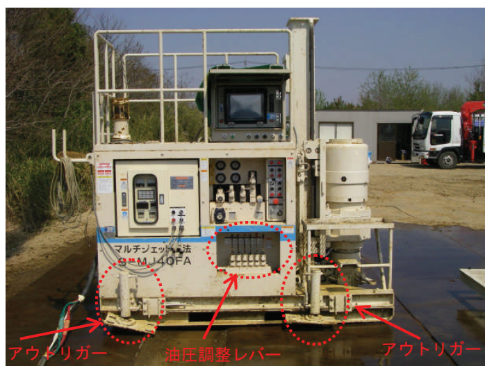
写真 2.36 アウトリガーおよび油圧調整レバー
