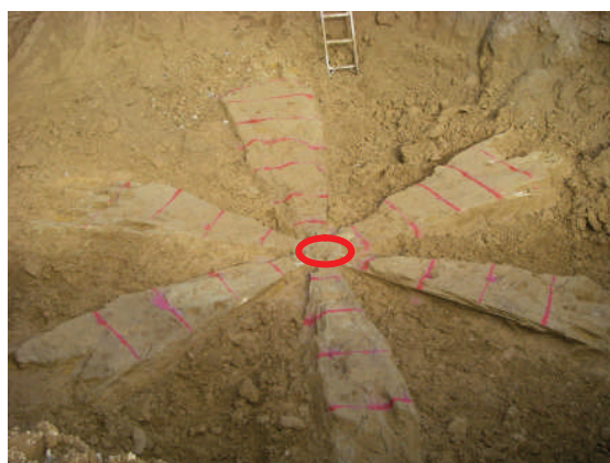
写真 2. 21 試験ケース (8-16, 8-19~22, 8-26) 多方向改良体 (砂礫地盤)
