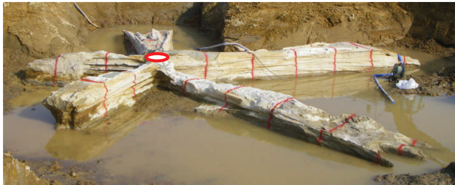
写真 2. 27 試験ケース (12-1～12-5) 5 方向改良体 (砂質土地盤)
