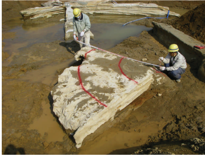
写真 2.28 試験ケース(12-6) 扇形改良体(砂質土地盤)
