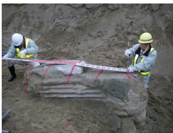
写真 2.19 試験ケース(6-1) 壁状改良体(砂質土地盤)
