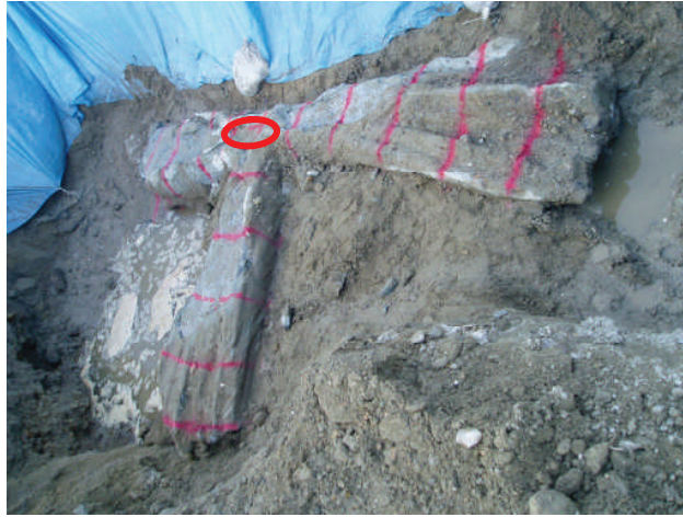
写真 2.18 試験ケース (5-6, 5-7, 5-8) 3 方向改良体 (砂質土地盤)
