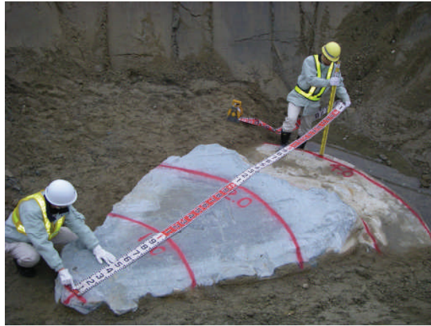
写真 2.20 試験ケース (6-2) 扇形改良体 (砂質土地盤)
