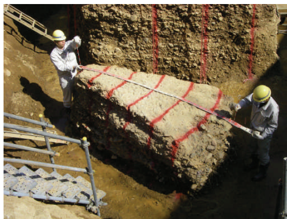
写真 2.23 試験ケース (8-28) 扇形改良体 (砂礫地盤)
