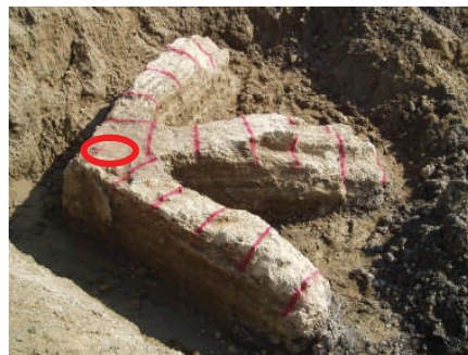
写真 2.25 試験ケース(9-1, 9-2, 9-3) 3 方向改良体(粘性土地盤)
