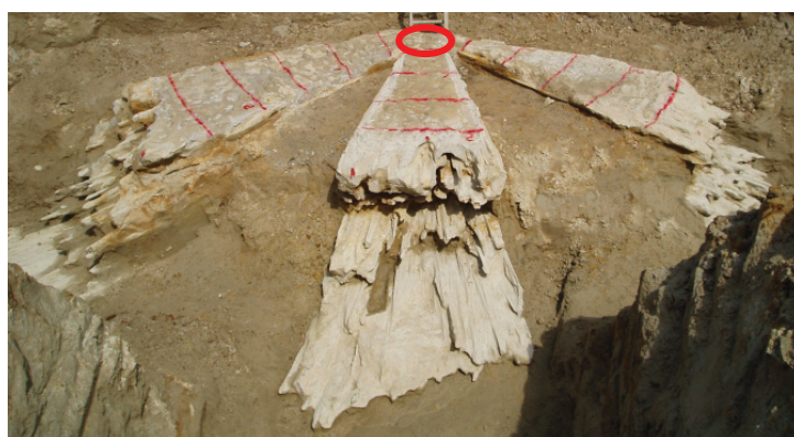
写真 2.16 試験ケース(2-5, 2-6, 2-7) 3方向改良体(砂質土地盤)
