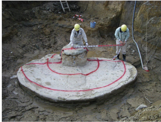
写真 2. 29 試験ケース (12-7) 扇形改良体 (砂質土地盤)
