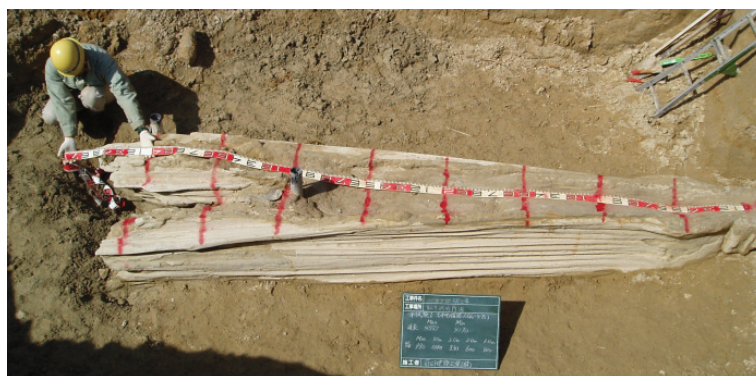
写真 2.15 試験ケース(2-4) 壁状改良体(砂質土地盤)
