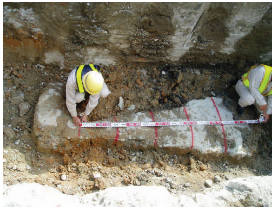
写真 2.17 試験ケース (5-5) 壁状改良体 (砂質土地盤)
