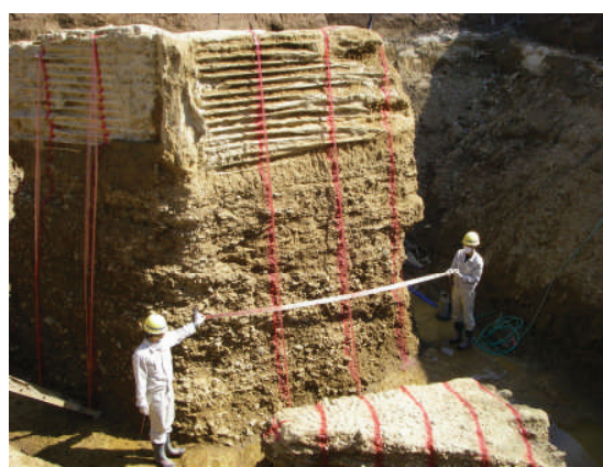
写真 2.24 試験ケース (8-29, 8-30) 2 方向改良体 (粘性土および砂礫地盤)
