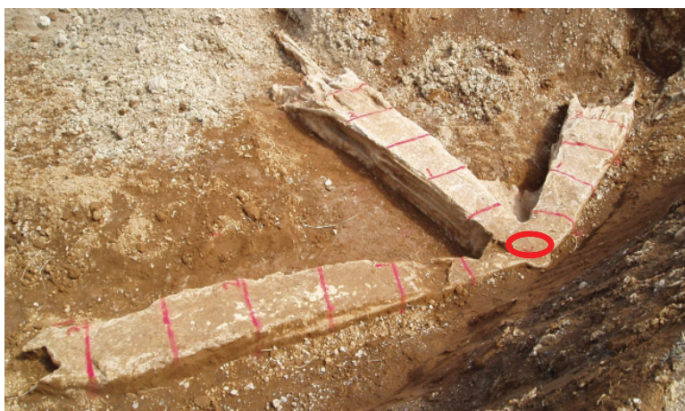
写真 2. 14 試験ケース (2-1, 2-2, 2-3) 3 方向改良体 (粘性土地盤)
