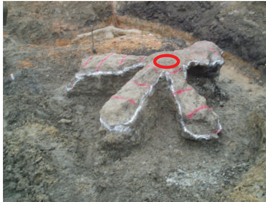
写真 2.26 試験ケース (9-7, 9-8, 9-9, 9-10) 多方向改良体 (砂質土地盤)
