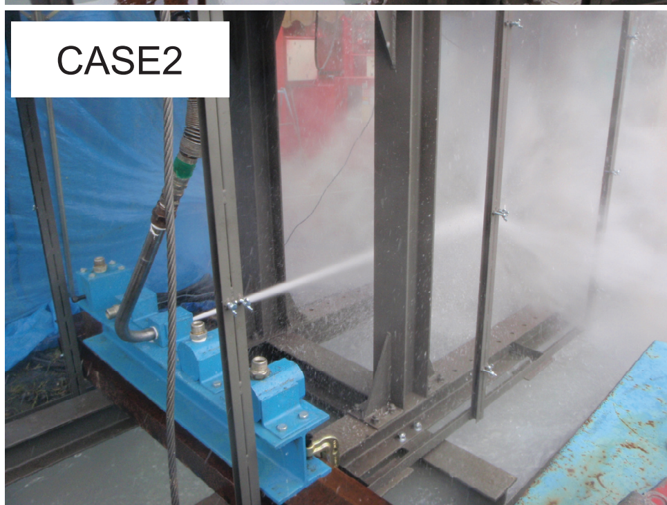
写真 2.11 ジェットの収束状況の比較
