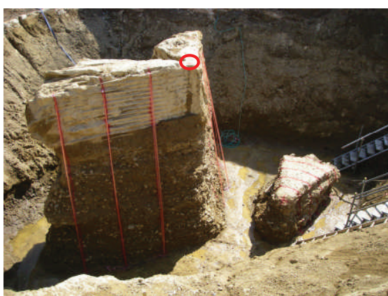
写真 2.24 試験ケース (8-29, 8-30) 2 方向改良体 (粘性土および砂礫地盤)
