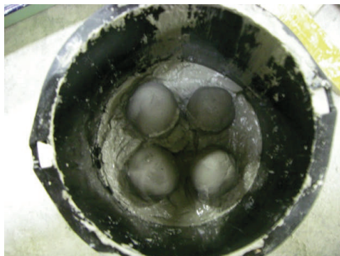
写真 4.2 ダマ混入供試体の作成状況
