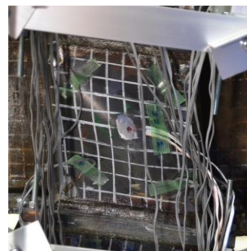
パネルのせん断座屈 (実験終了後の様子)
