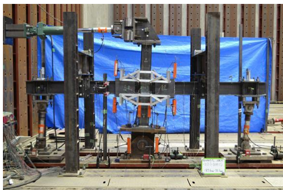
溶接部破断発生時の変形状態
