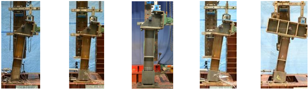
局部座屈 (元の状態) 補修部上部の局部座屈 亀裂 (スカラップ) 亀裂 (フランジ) 補修部位の変形の進行
