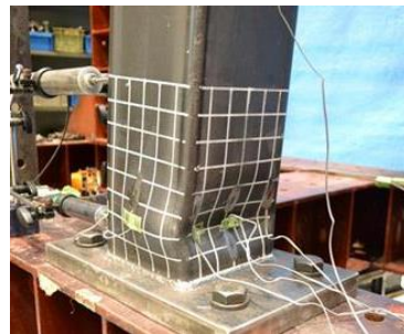
柱脚部の局部座屈 (終局状態)
