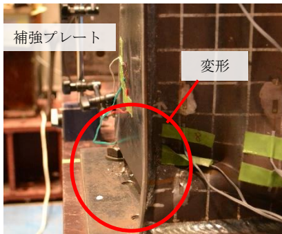
補強プレートの変形
