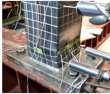
柱脚部の局部座屈 (終局状態)
