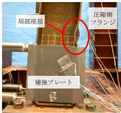
圧縮側フランジの局部座屈
