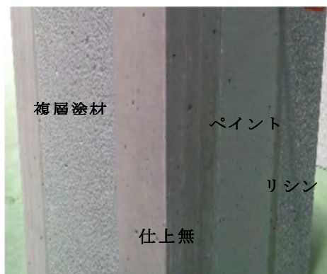
写真 2-2 コンクリート供試体
