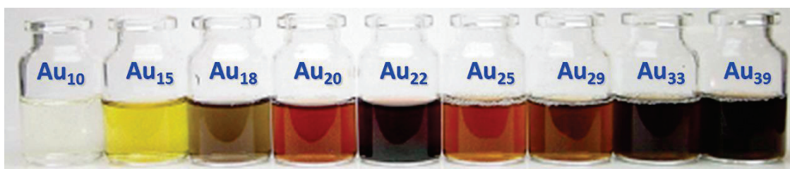
Figure 1-2. 精密合成された金クラスター水溶液の写真. (許可を得て Ref. 2 より作成)
