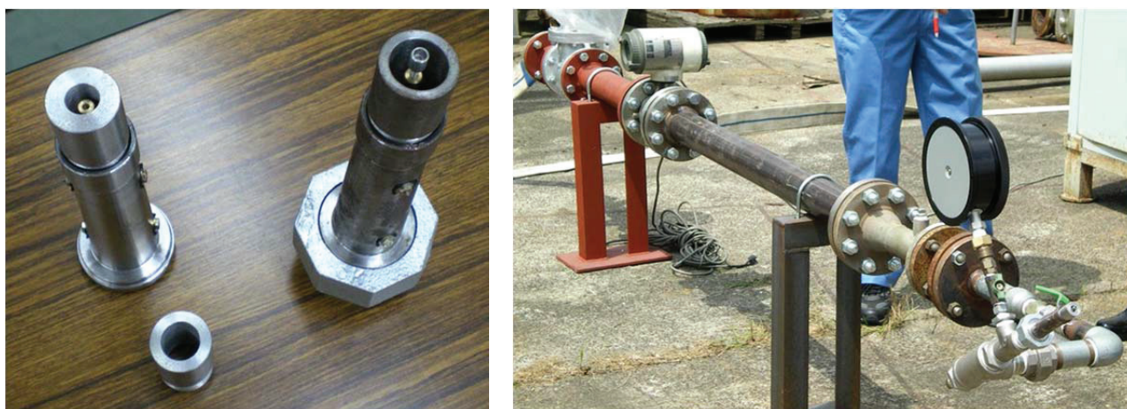
図 1.4.1 実験で使された放射ノズル
