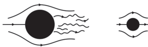
図5 小さな物体を回り込む流れは整っており(層流)、大きな物体とは大きく異なる
